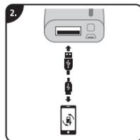
2. Verbinden Sie das Endgerät mit der Powerbank um den Ladevorgang zu starten. Der Ladevorgang startet automatisch. Ist der Ladevorgang vollständig abgeschlossen, schaltet sich die Powerbank automatisch ab. Trennen Sie anschließend das Kabel von der Powerbank.
