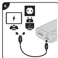
4. Laden Sie die Powerbank über Micro USB Buchse auf. Verbinden Sie hierzu das Ladekabel entweder mit einem bus-gespeisten USB Anschluss Ihres Computers, oder mit einem separaten Netzteil.
