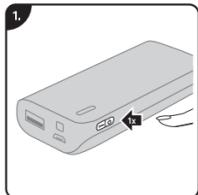
Drücken Sie die Funktionstaste an der Seite einmal, um die Powerbank einzuschalten. Über die blau aufleuchtenden LEDs lässt sich der aktuelle Ladestand des Akkus ermitteln:
