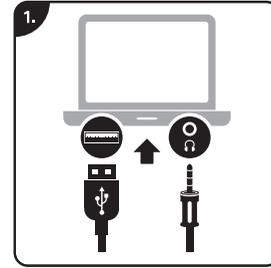
1. Verbinden Sie die Lautsprecher über das 3.5mm Audio-Kabel und USB Kabel mit Ihrem Computer und schalten Sie die Lautsprecher anschließend ein. Die Lautsprecher werden automatisch erkannt und sind sofort einsatzbereit.
