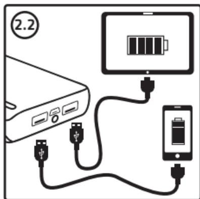
**Hinweis:** Die maximale Ausgangsleistung (Stromabgabe) der Powerbank beträgt 3.0A: Sofern Sie zwei Endgeräte mit einem höheren Bedarf angeschlossen haben, wird der Ladevorgang nicht gestartet. Laden Sie Ihre Geräte in diesem Fall einzeln.
